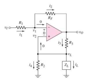
$$\frac{v_I - i_L Z_L}{R_1} = \frac{i_L Z_L - v_O}{R_F}$$
